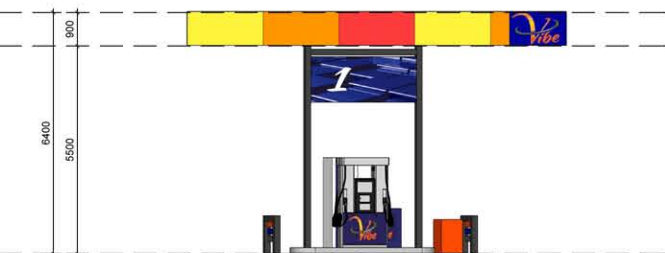
6 SIDE ELEVATION - CANOPY SCALE: 1:100 @ A1
